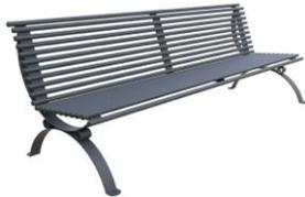
**Panchina** costituita da n. 2 basi in ferro piatto 60x6 mm, centinato e decorato con tubolare mm 48 x 3. Spalliera e seduta costituite da n° 22 tubi tondi Ø mm 25 con tappi in plastica. Interamente zincata a caldo e verniciata a forno con polvere epossidica, uguali a quelle posizionate in Piazzetta Orsini
