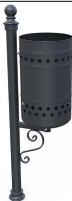
**Cestino** di forma cilindrica, in lamiera zincata spessore 10/10. Fondo sagomato in lamiera in acciaio zincata spessore 15/10 con fori di scarico delle acque meteoriche.
